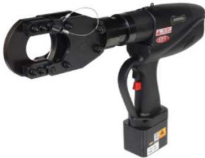
Herramienta electro-hidráulica para corte de conductores de cobre o aluminio de hasta 52 mm de diámetro. Compacta, silenciosa y fácil de operar con una sola mano gracias a su reducido peso y bajo nivel de vibraciones. Diseño ergonómico para garantizar el confort del operador. Desarrolla una fuerza de 12 toneladas, con batería de Ni-MH de 14.4 V. Posee cuchillas de acero de gran resistencia, cabezal giratorio 180° y válvula de corte automático. No corta conductores de aluminio-acero.
