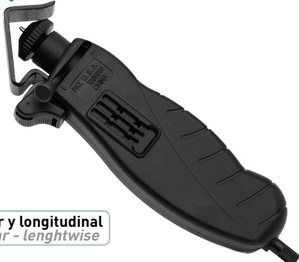
Herramienta pelacable del tipo circular y longitudinal. Posee un novedoso sistema de desvainado, para facilitar el preparado de conductores ya sea para derivaciones o puntas de conexión. Permite realizar desvainados sectoriales en el conductor sin necesidad de cortarlos y empalmarlos, ya que cuenta con una cuchilla regulable en altura para no dañar el núcleo del conductor.
